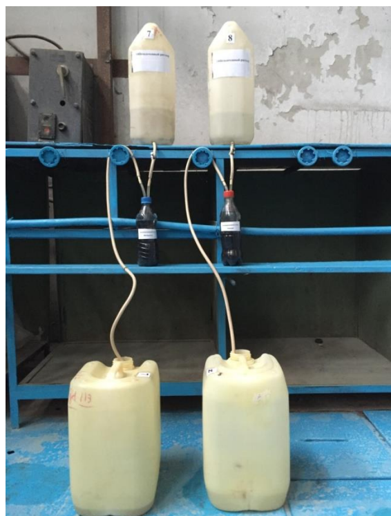
11 Сурет – Өнімді ерітінділерден алтынның сорбциясын жүгізуге арналған қондырғы
