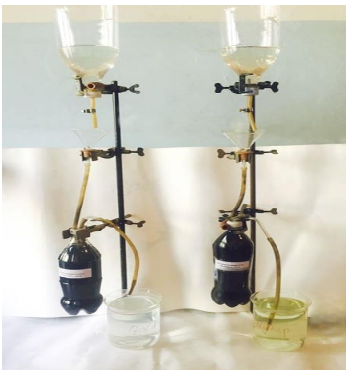
5 Сурет – Ағынды суларды белсендірілген көмірмен сорбциялық тазартуға арналған қондырғы (сол жақта – Goldcarb көмірі, оң жақта-Шұбаркөл көмірі)
